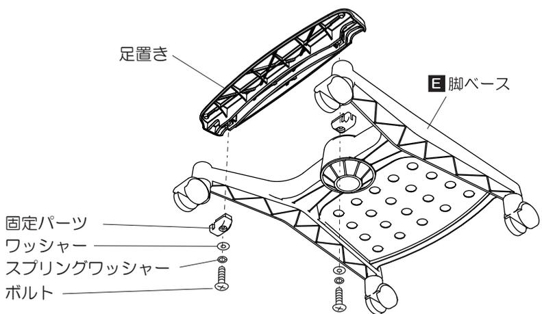
足置きをはずすと、足置きの内側から固定用のナットが抜け落ちてきます。（左右合計2個）一度ははずすと取付けにくいナットですので注意してください。
